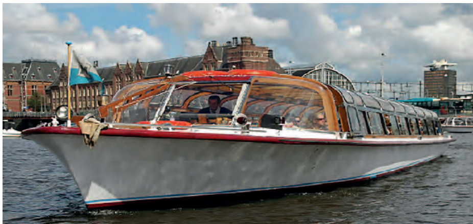
De klassieke rondvaartboot heeft vaak veel aantrekkelijke nautische details; houten mast, boordverlichtingsbakken, vlaggenstok, rvs-scheepstoeter, kikkers en zoeklicht.
