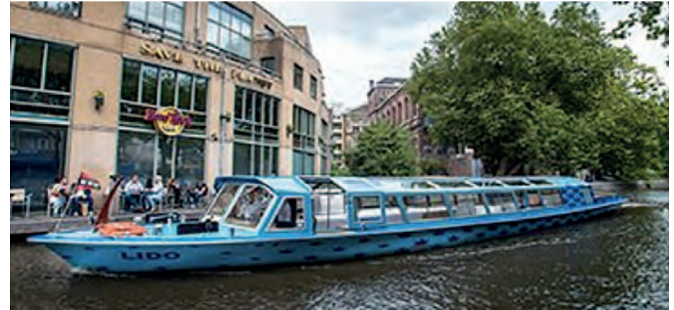
De romp van deze rondvaartboot van het Amsterdamse grachtentype is mooi gelijnd, heeft een oplopende steven, een bescheiden hoogte en breedte en laat het voor- en achterdek vrij.
