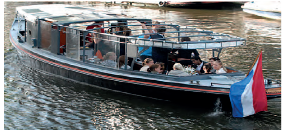
Dit salonvaartuig heeft geen vaste constructie voor het dak over de gehele lengte van de opbouw en de opbouw bestaat voor meer dan 1/3 uit tentdoek en plexiglas.
