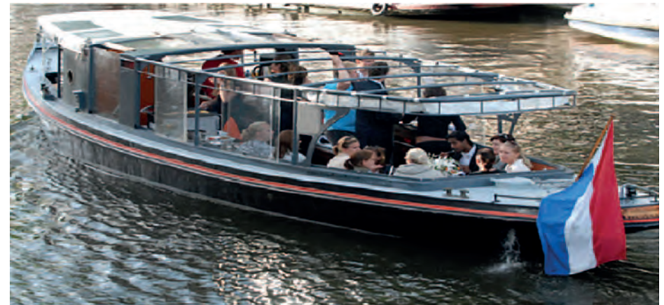
De opbouw van dit salonvaartuig heeft geen vaste constructie voor het dak over de gehele lengte van de opbouw en de opbouw bestaat voor meer dan 1/3 uit tentdoek en plexiglas.
