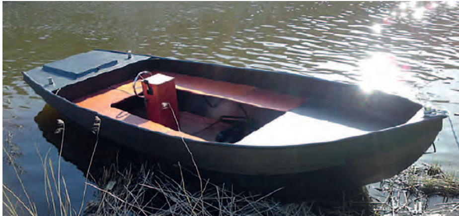
De romp van deze vlet heeft een duidelijke zeeg, sierlijke lijnen en rondingen en is symmetrisch over de lengteas.
