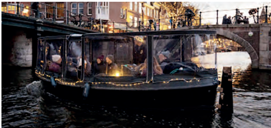
De gedeeltelijk wegneembare overkapping van deze sloep is van hard kunststof.
