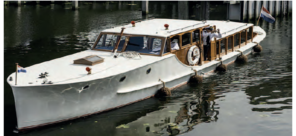
De romp van dit salonvaartuig van het type bakdekker heeft een mooi gelijnde romp met een uitgesproken voor- en achtersteven.
