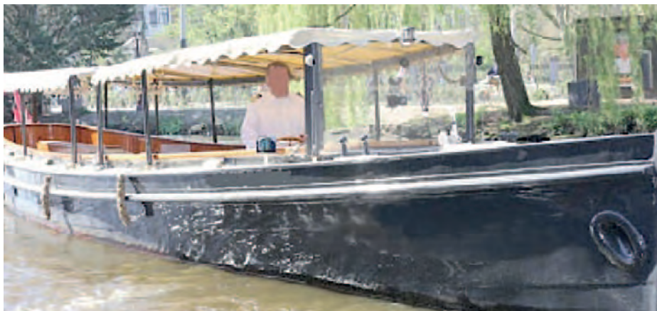
De raampartijen van de wegneembare overkapping hebben geen stijlen en doorzichtige delen in een passende verhouding en het geheel onvoldoende zorgvuldig uitgevoerd.
