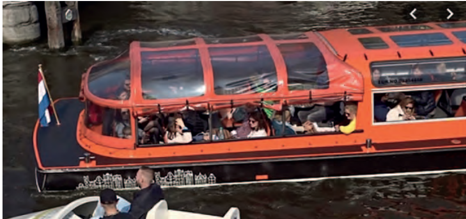
Dit vaartuig heeft een wegneembare overkapping met transparant materiaal van zacht kunststof aan de bovenzijde in plaats van zeildoek of hard kunststof.
