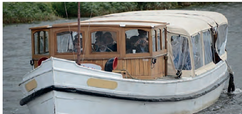
De wegneembare overkapping is niet zorgvuldig ontworpen en strakgespannen uitgevoerd.
