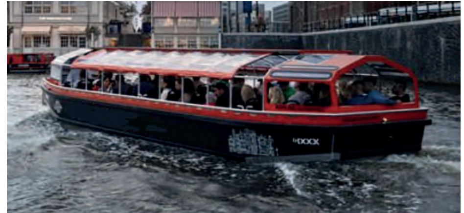
Dit vaartuig gebruikt zeil met transparante kunststof delen in grote oppervlakken.
